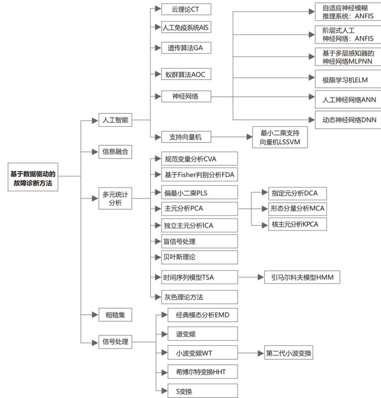
图1-9 基于数据驱动的故障诊断方法
