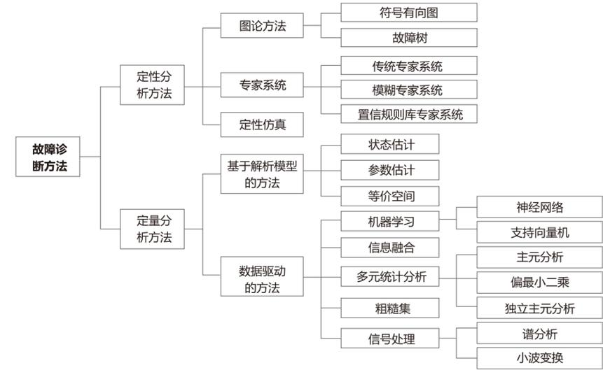
图1-8 故障诊断方法分类
