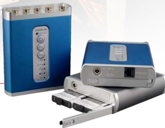
Spider-20/20E是一款紧凑而强大的动态信号分析仪和数据记录仪。它提供4个24位高精度高保真输入通道，和一个独特的软件可选的转速计输入信号源输出通道（使用传统的BNC连接器）。每个输入可单独编程接受AC或DC电压或从一个内置电子IEPE(ICP)传感器输出。
